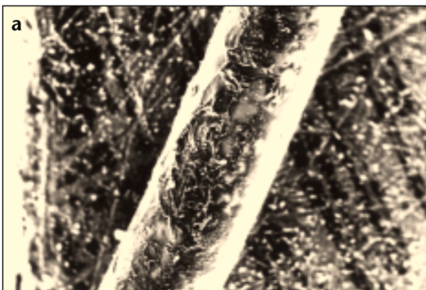
Εικ. 4: Εικόνα δευτερογενούς εκπομπής επανακτηθέντος σύρματος NiTi μετά από έκθεση 6 μηνών στο στόμα ασθενούς.
