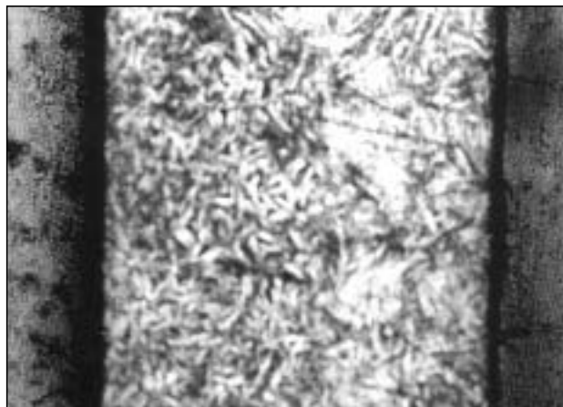
Εικ. 5. Εικόνα οπτικού μικροσκοπίου επανακτηθέντος, μεταλλογραφικά λειασμένου σύρματος, όπου διακρίνεται η καταστροφή του μαρτενσιτικού δικτύου κρυστάλλων στην δεξιά περιοχή. (Μεγέθυνση X 80).
