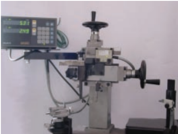
Εικόνα 2. Η συσκευή TARG+TR (Torque Angulation Reference Guide + Thickness & Rotation) system.
